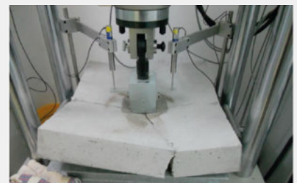
EFNARC plate test - EN 14488-5
